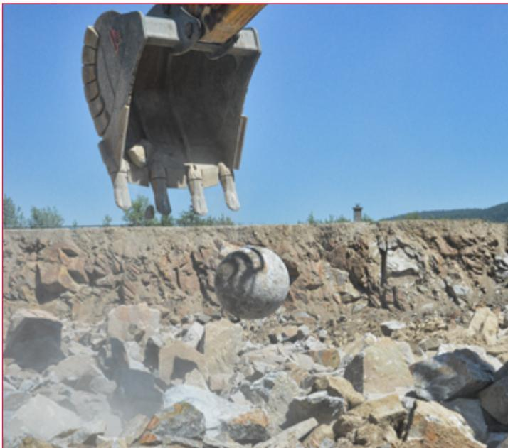
**Fallkugeln geliefert von RENOMAG gekennzeichnet sich mit Qualität Stahlguss aus Material ČSN 42 2643 (GS 45.3) mit ausgezeichneter Haltbarkeit, dadurch helfen die allgemeine Betriebs- und Produktionskosten zu senken.**
