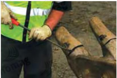
**Krok 4:** V některých případech může vyjmutí zubů bránit napěchovaný materiál. Nasadte páčidlo na zadní patku zuba a zkuste zub pohybem uvolnit.
