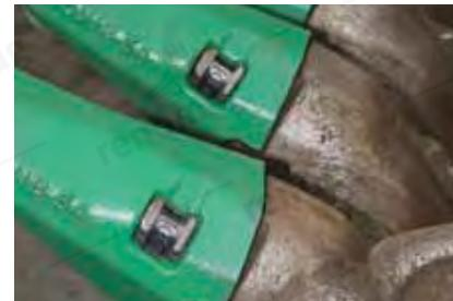
**Krok 9:** V plně uzamčené poloze spočíne horní část zámku pod povrchem zuba.
