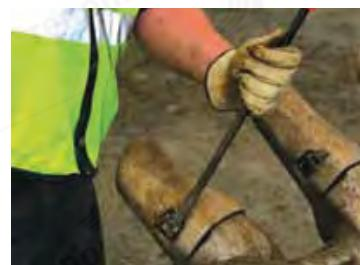
**Krok 3:** Zasuňte pácidlo do druhé drážky a opět jím tlačte směrem ke středové ose zuba až do okamžiku, kdy se objeví tři drážky. Zámek zůstává stále vsazen v těle zuba.
