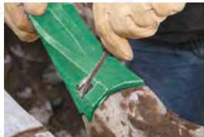
**Krok 8:** Páčidlo zasuňte do dolní části zámku a opřete o stěnu zuba. Tlačte jím směrem ke středové ose zuba, až zámek zaklapne. Zaklapnutí musíte zřetelně slyšet. Jen pak je zub správně nasazený.
