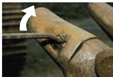
**Krok 2:** Zasuňte pácidlo do horní drážky zámku a za natáčení nahoru jím tlačte směrem ke středové ose zuba. Očištěním zaváde drobného cizího materiálu druhou drážku v zámku, která se nyní odkryje.
