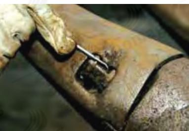
**Krok 1:** Vycištěním zaváde horní i dolní část otvoru zámku drobného cizího materiálu.
