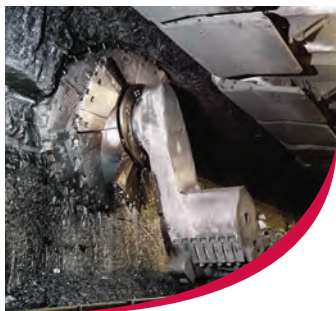
Válec kombajnu při práci
